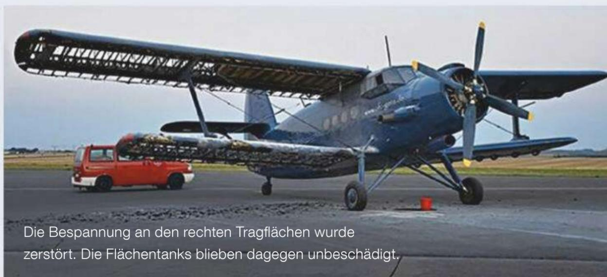
Die Bespannung an den rechten Tragflächen wurde zerstört. Die Flächentanks blieben dagegen unbeschädigt.
