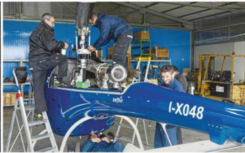
Die Einwellen-Gasturbine liefert die tschechische Firma PBS. Das Aggregat leistet maximal 245 PS, ist im Zefhir allerdings auf eine Dauerleistung von 141 PS gedrosselt. Vorteile der Turbine sind das im Vergleich zum Kolbenmotor kleinere Einbaumaß und das geringere Gewicht.
