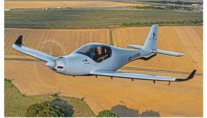
Der schwedische UL-Renner mit Einziehfahrwerk ist für 600 kg ausgelegt.
