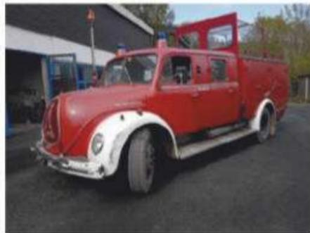
**TOST Startwinde**, Magirus Fahrgestell, fahrtüchtig, nicht für Straße zugelassen; neue Batterien; Schleppmotor: Mercedes Benz 6,3l V8 250 PS; 600 Nm Drehmoment; zulässige Flugzeugmasse: 750 kg, VB 6000,- €. [sj.aachen@freenet.de](mailto:sj.aachen@freenet.de)
