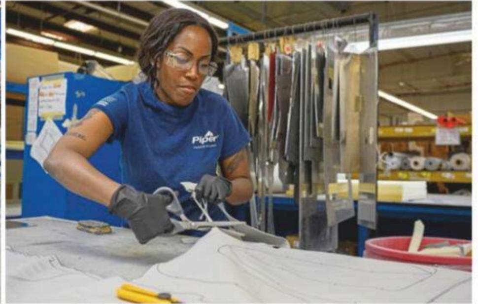
Piper zeichnet sich durch seine hohe Fertigungstiefe im eigenen Haus aus. Auch das Interieur entsteht in Vero Beach. Die beiden Fotos zeigen einen Teil des Prozesses vom Rohstoff Leder zum einbaufertigen Flugzeugsitz.
