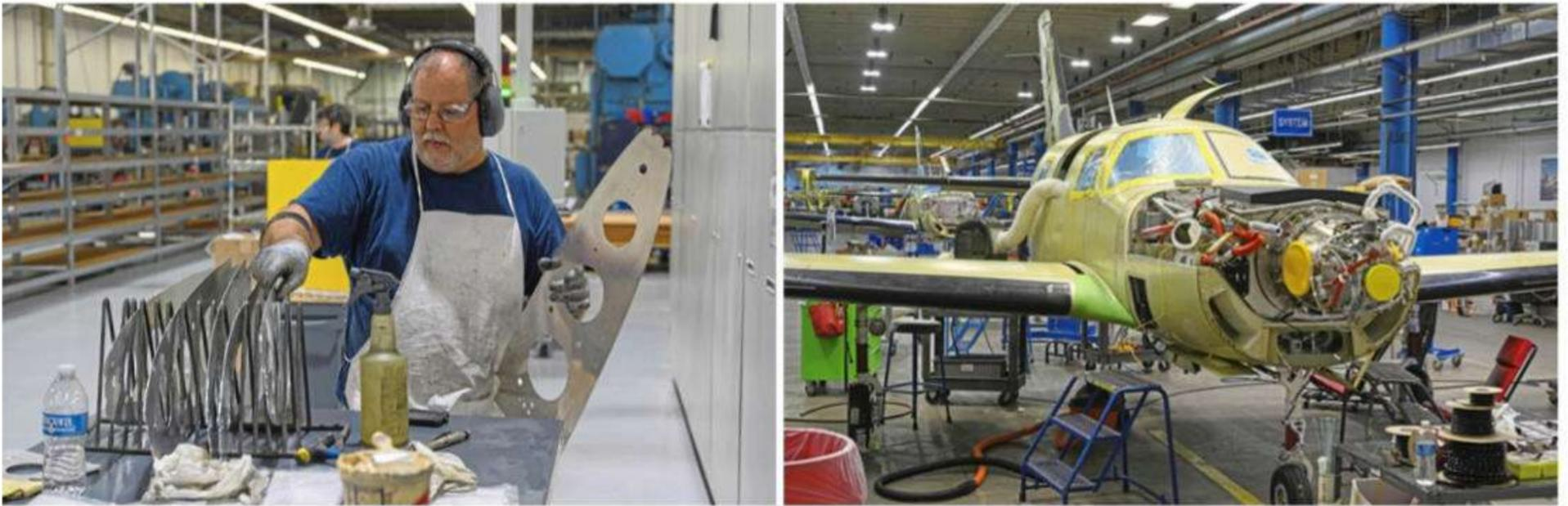
Moderne Maschinen helfen bei der Fertigung der Metallteile. Das linke Foto zeigt die Flügelrippen, bevor sie in die Presse kommen. Rechts wartet eine Turboprop M-Klasse auf ihre Fertigstellung.
