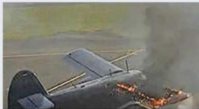
Leicht entzündlich: Von der unteren greift der Brand rasch auf die obere Tragfläche über. Hier befinden sich drei große Kraftstofftanks.
