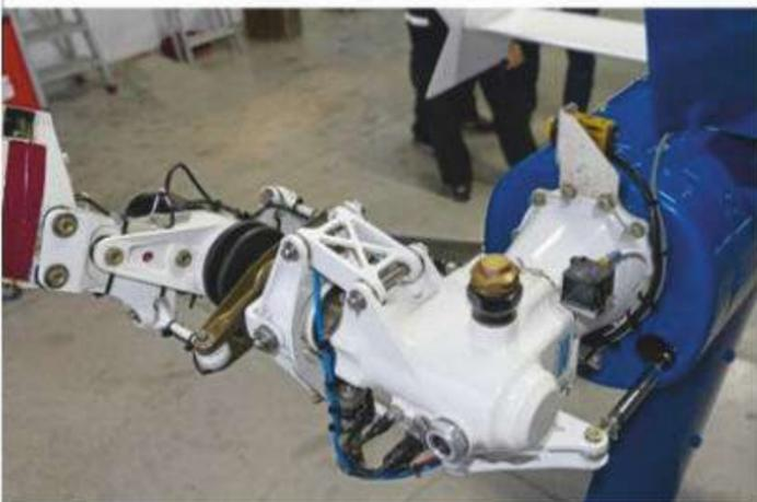
Im Heckrotorgetriebe befinden sich Sensoren für Drehzahl, Öltemperatur und Späne.
