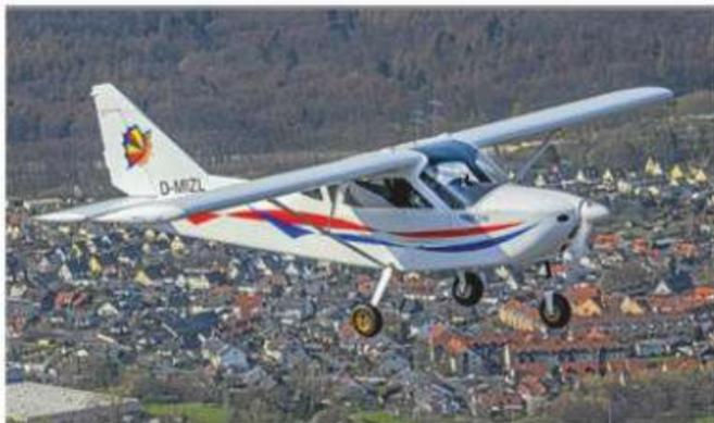
Ein robustes Arbeitsgerät, jetzt auch für 600 Kilogramm MTOW zugelassen.
